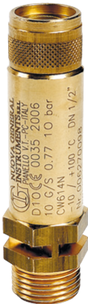
fig 906 messing veiligheidsklep 1/4" - 2" bsp / vrije uitlaat huis : messing CW614N viton zitting temp. : -10°C/+160°C insteldruk : 0,5 - 12 bar (elke 0,5 bar) bijzonder geschikt voor perslucht
